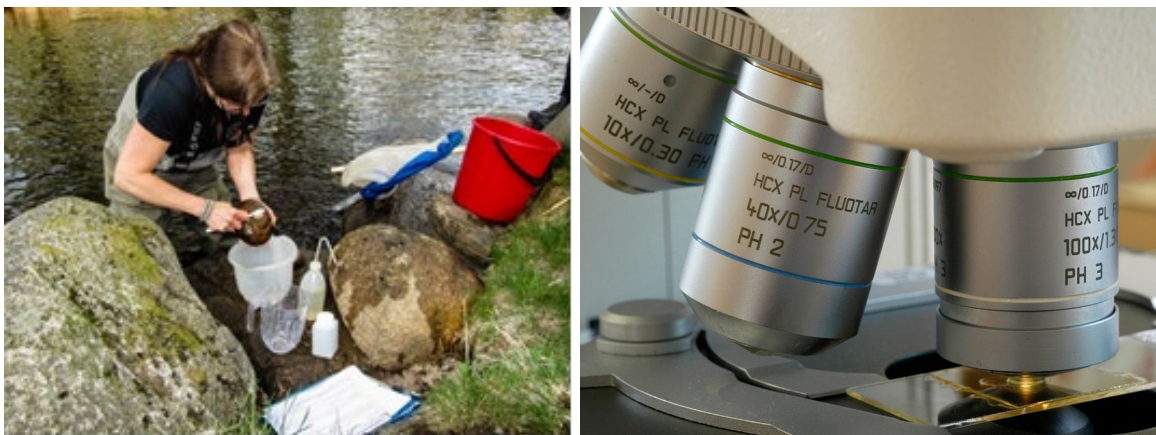
Figur 33. Provtagning av kiselalger görs i första hand genom borstning av stenar varefter kiselalgspreparat framställs och analyseras i ljusmikroskop med 1000 gångers förstoring (objektiv 100x), © Sweco Sverige AB
