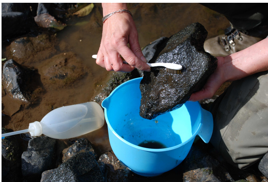
Figur 28. Påväxtmaterialet borstas av från stenar med en ren tandborste. Materialet sköljs därefter av med åvatten och samlas upp i en vanna/bunke (foto: Medins Havs och Vattenkonsulter AB).
