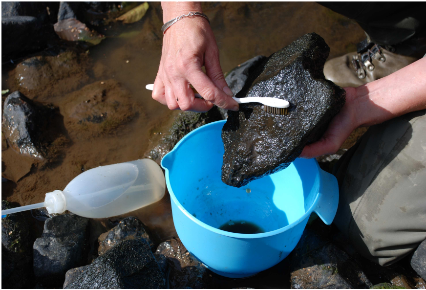
Figur 21. Påväxtmaterialet borstas av från stenar med en ren tandborste. Materialet sköljs därefter av med åvatten och samlas upp i en vanna/bunke (foto: Medins Havs och Vattenkonsulter AB).
